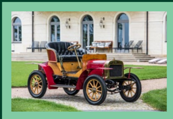
L&K Voiturette A (1905. - 1907.) Prvi automobil proizveden u Mladá Boleslavu raspolagao je sa sedam konjskih snaga i mogao je postići brzinu od 40 km/h.
