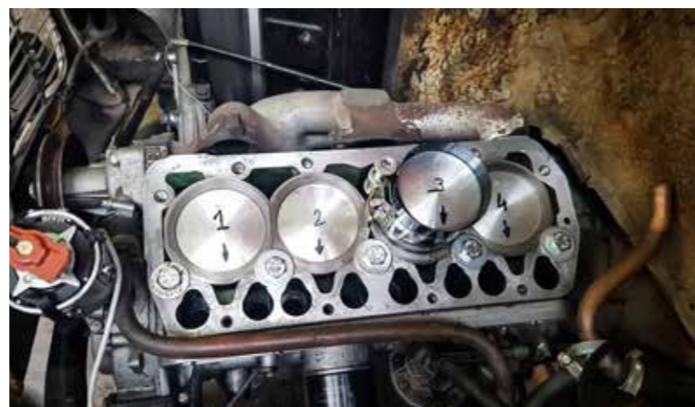
Motor je petrio temeljit remont u koji su ugrađeni originalni dijelovi.
