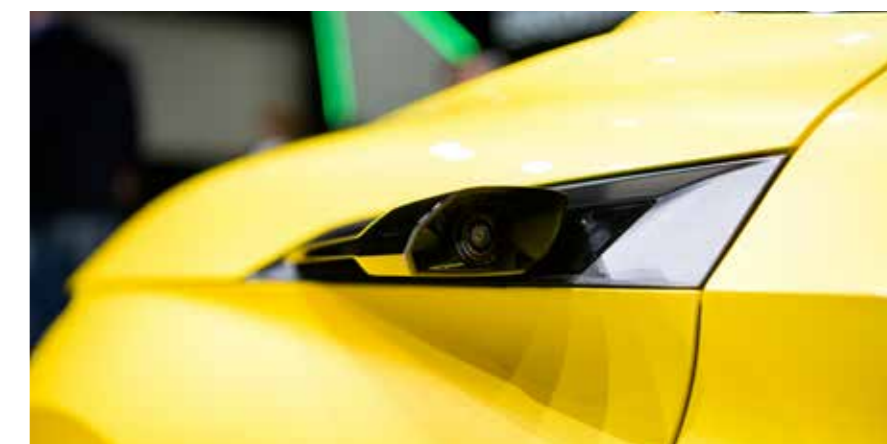
Umjesto klasičnih vanjskih ogledala koriste se kamere čija kućišta vizuelno podsjećaju na peraje morskog psa.
