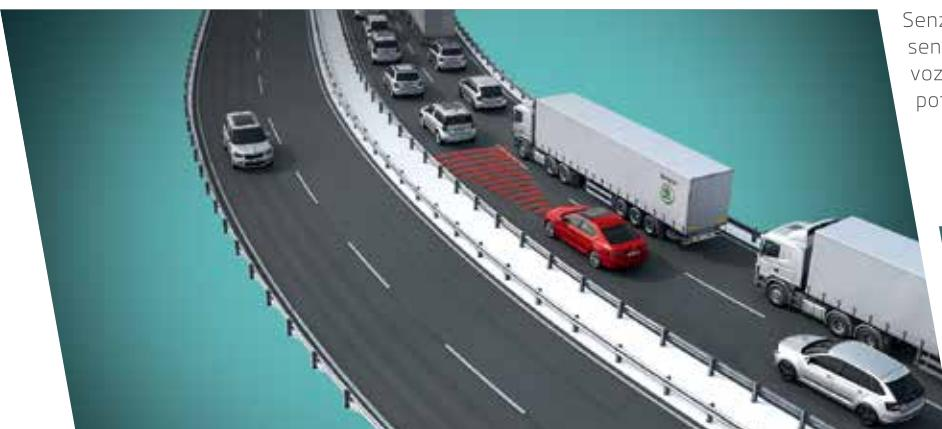
Potpore kod prometnog zastoja je funkcija dizajnirana za olakšavanje vožnje vozila opremljenih DSG mjenjačem u prometnim zastojima. Ona pokreće, koči i skreće vozilo upravljanjem motorom, kočnicama i kolom upravljača radi oponašanja kretnji okolnih vozila (pri brzinama do 60 km/h).
