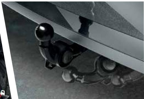
Mehanizam za vuču ima sklopivu kuku kojom se upravlja preko ručke prtljažnika. Zahvaljujući ovoj inovaciji ne morate ukloniti kuku za vuču nakon korištenja, a ona neće narušavati elegantan izgled Vašeg automobila.
