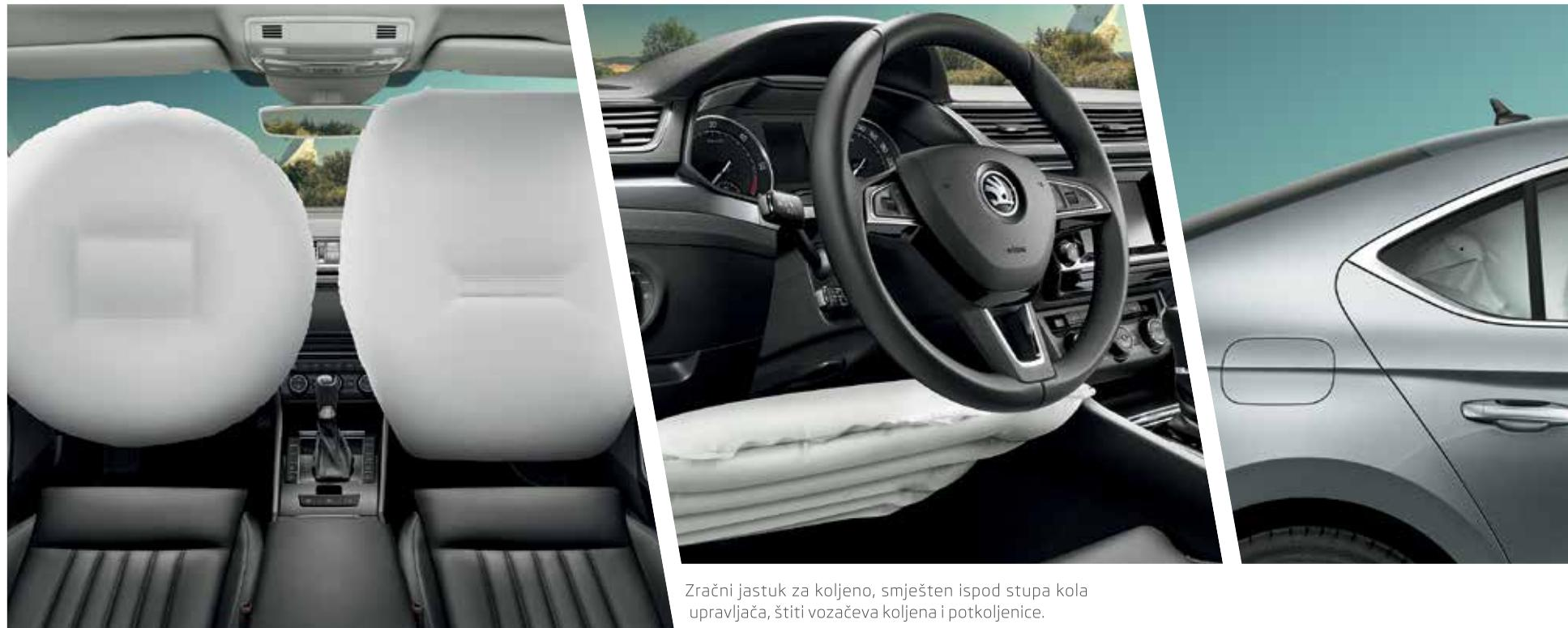
Zračni jastuk za koljeno, smješten ispod stupa kola upravljača, štiti vozačeva koljena i potkoljenice.
