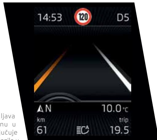
Drugi sustav potpore koji upotrebljava višenamjensku kameru smještenu u unutrašnjem osvrtnom zrcalu uključuje sustav Lane Assist za zadržavanje vozila u voznoj traci.
