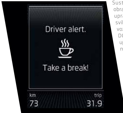
Sustav prepoznavanja umora obrađuje podatke senzora servo upravljača radi prepoznavanja svih vrsta naznaka umora kod vozača. U tim slučajevima Maxi DOT - višenamjenski zaslon upozorava vozača da bi trebao napraviti stanku.
