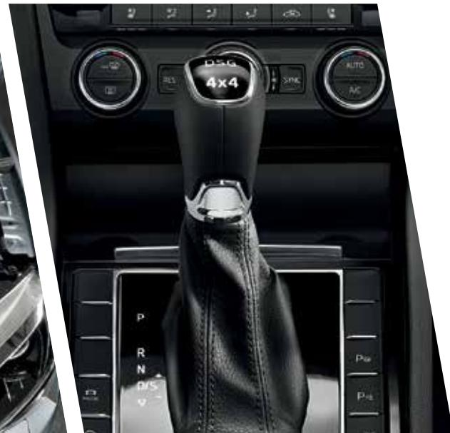
Ovisno o varijanti motora, ovaj automobil može se opremiti ili 6-stupanjskim ili 7-stupanjskim automatiziranim mjenjačem s dviće spojke DSG. Kao savršenu kombinaciju preporučujemo 6-stupanjski DSG mjenjač i pogon na sve kotače.
