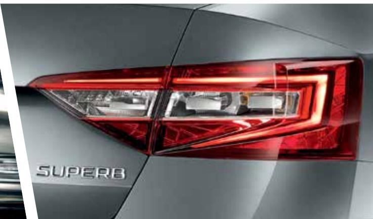
Kristalni elementi također se pojavljuju u „neaktivnom“ području integriranih stražnjih svjetala, a raspoloživi su u dvjema varijantama. Žarulje za svjetlo za vožnju unatrag i žmigavce, kao i LED dio svjetala za maglu, skriveni su iza „dragulja“, što izgled svjetala novog Superba čini još karakterističnijim.
